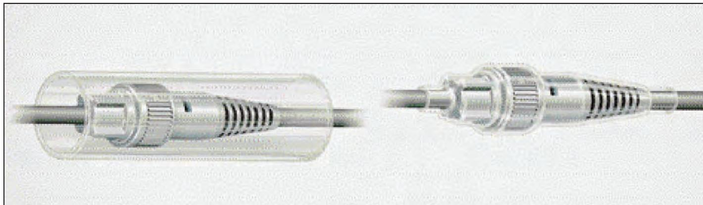
ZEUS Dual-Shrink<sup>®</sup> ふつ素樹脂PTFE/FEPチューブは、外層のPTFE熱収縮チューブと内層のFEPチューブから構成されています。ワイヤー、ケーブル、コネクター、スライス、ターミナル等に密着し、取り扱いの容易さ、気密性および防湿性にも優れています。外層PTFEを加熱することで対象物に収縮すると同時に、溶融し流れだしたFEPが固体または半固
